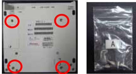
同梱の専用ネジを、本体裏面に図のように取り付けてください。
