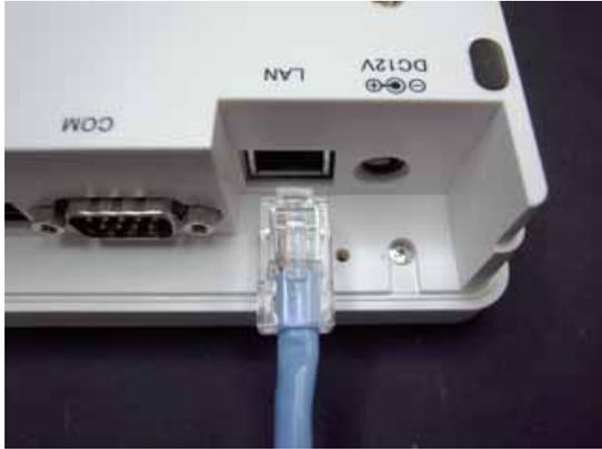
爪が確実にロックされ、抜けぬ事を確認します。
