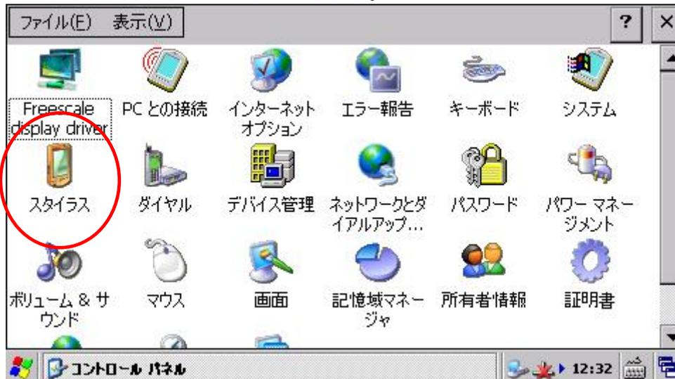
タッチスクリーンの補正タブを選択します。
