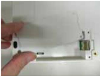
DI/DO ケーブルが、本体の外側に引き出せるように、本体側および電池蓋側の切り欠き部分を割って、同梱の DI/DO ケーブルを、基板上的コネクタに取り付けてください。
