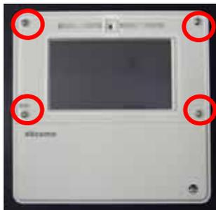
亚克力パネルをはずして、LCD 保護パネルを取り付け、+ ネジを取り付けます。LCD 保護パネルを取り付けるとタッチパネルが操作出来ませんので予め設定を終わらせて下さい。
