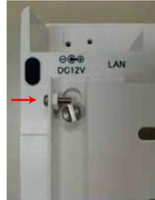
ブラケット取り付けネジ穴は、VESA (Video Electronics Standards Association) 規格の内、100mm × 100mm に準拠しています。75mm × 75mm の穴ピッチに対応した製品に取り付ける場合は、市販の変換金具をご使用ください。M4 のネジで固定可能です。
