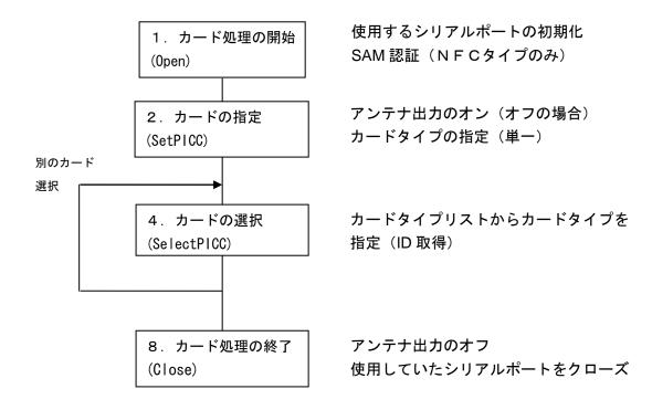
RFID API は、「rfidapi.dll」内に存在する。API をコールする際の、DLL呼び出し方法例として、RFID 共通インターフェースをコールする際の関数ポインタ取得方法を下記に記す。なお、. NET アプリケーションの場合は、dllimport を使用することで、下記は不要となる。
